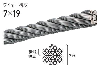
素線径が細いため、軟らかいので、ワイヤークリップの使用に適しています。
