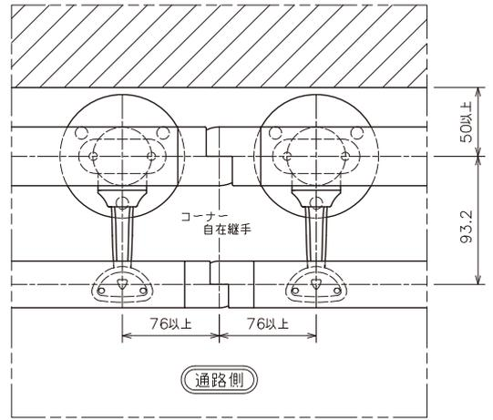
※水平の連結は、ジョイント継手を使用してください。
